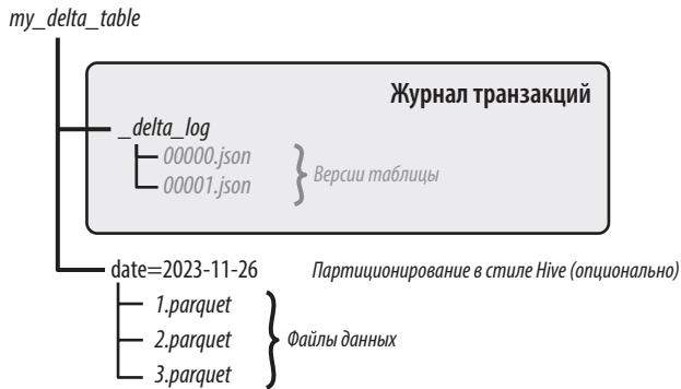
Рис. 1.5. Структура таблицы Delta Lake, включая журнал транзакций и файлы данных (изображение взято из блога Дэнни Ли) 1
