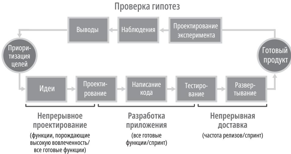
**Рис. 1.1.** Цикл разработки продукта
